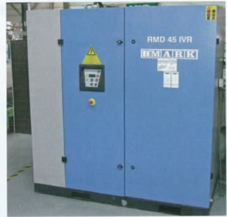
Dank des geringen Geräuschpegels konnte der drehzahlregulierte Kompressor direkt in der Halle installiert werden
